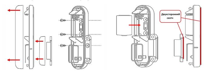
Внимание! Магнит должен быть установлен на створку окна! Максимальное расстояние между датчиком и магнитом не должно превышать 15 мм.
