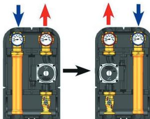
**Внимание!** Все насосные группы укомплектованы обратным клапаном, вмонтированным в запорный узел обратной линии. Обратный клапан может быть принудительно «отключен» путем поворота рукоятки запорного крана в положение 45° «Отключение» обратного контура.
