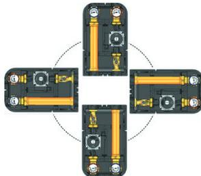
Насосная группа прямого контура поставляется в заводской конфигурации с циркуляционным насосом справа и подачей воды вверх. Допускается реверсивная сборка на месте производства работ. Для этого достаточно заменить линию подачи на линию возврата. Чтобы электронная часть насоса оставалась внутри теплоизоляции, некоторые модели требуют ее поворота, при этом положение самого насоса не изменяется.
