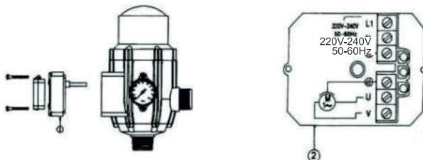
При использовании блока автоматики с трёхфазным или однофазным электронасосами, у которых максимальный ток выше 10 А, используйте электромагнитный пускатель.
