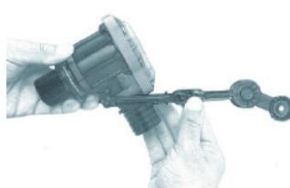
Установите рычаг и зафиксируйте его.
