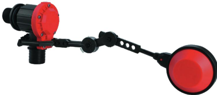
Поплавковый выключатель предназначен для контроля наполнения емкости питьевой водой, технической водой и другими не агрессивными жидкостями. Клапан разработан для предотвращения перелива воды. Он самостоятельно прекращает её подачу, когда уровень жидкости достигает выставленной отметки. Поток возобновляется, при снижении уровня ниже установленного.
