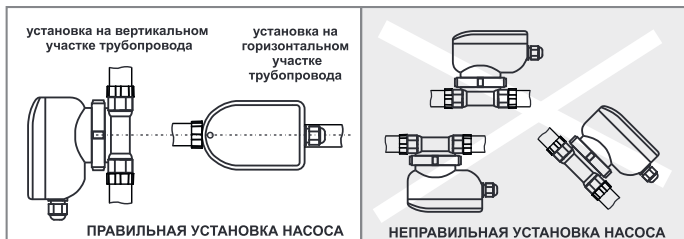
Рис.3 Установка циркуляционного насоса
